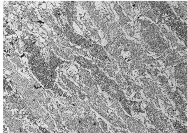
**Figure 1d: Weld1-Weld metal@200X**
